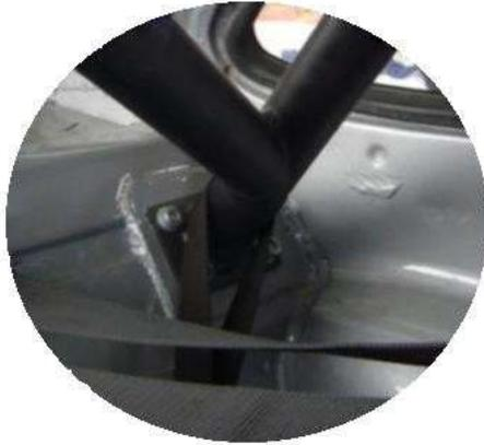
Fijación atornillada de tirantes traseros mediante pie de anclaje y placa de refuerzo de 60 cm<sup>2</sup>
