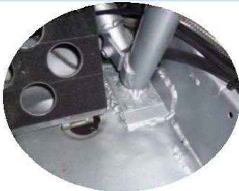
**Fijación atornillada mediante pie de anclaje con placa de refuerzo en forma de cajetín**
