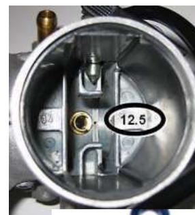
Orificio angular de los insertos del carburador
