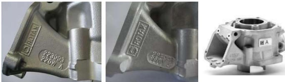
**125 Max DD2 (DD2 Senior, DD2 Master, DD2 Super Master y DD2 Promocional):** Cilindro con un puerto de escape principal y dos puertos de escapes laterales y sin válvula de escape. Sólo se pueden utilizar los cilindros marcados con el código de identificación 613932, 613933 ó 613934.
