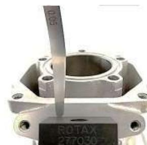
La medición debe realizarse fuera del área de contacto de la válvula de escape indicada en rojo.
