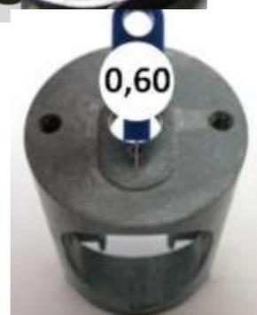
Orificio vertical de los insertos del carburador
