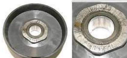
La zona de contacto entre el embrague y el tambor del embrague debe ser seco en cualquier momento - no se permite lubricación.
