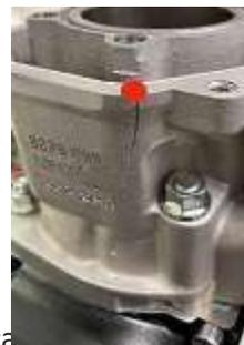
Ejemplo 2, reparación del área de la brida de la válvula de escape. Permitido únicamente códigos de identificación de cilindro 223933 y 613933.
