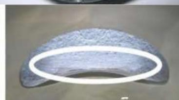
El puerto de escape puede mostrar un pulido manual parcial realizado por el fabricante para eliminar defectos de fundición menores y/o para eliminar la rebaba de NIKASIL al final del revestimiento de NIKASIL (ver imagen superior derecha).
